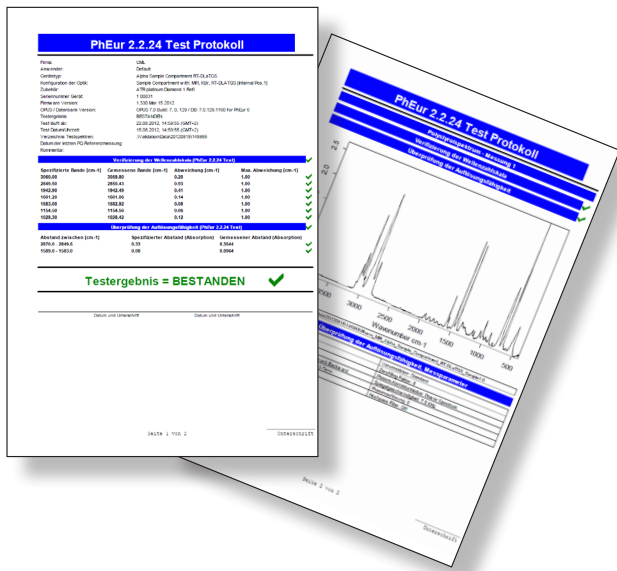
Abb. 5: Automatisch erstellte Dokumentation des ALPHA Gerätetests gemäß der Vorschrift des Ph. Eur. Kapitel 2.2.24.
