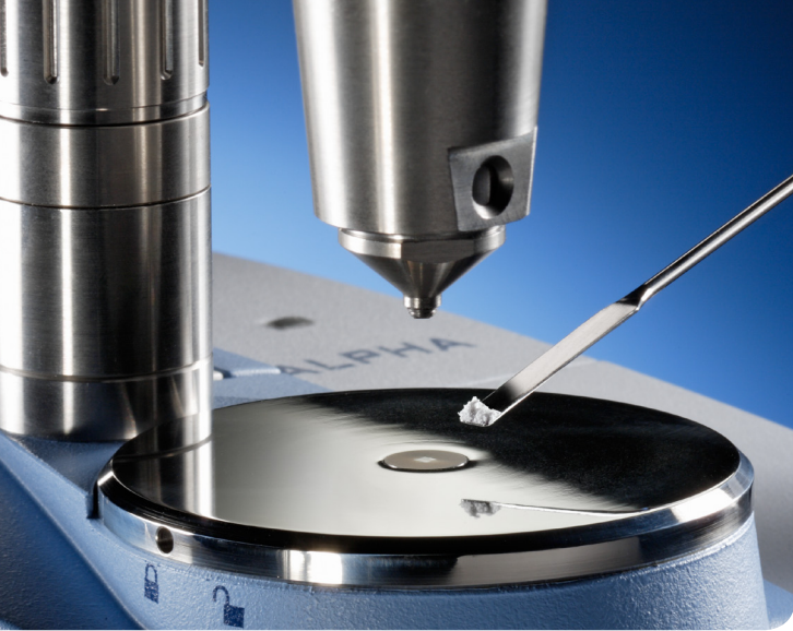
Abb. 1: Aufbringung der Probe auf dem Diamant ATR-Kristall zur Vermessung mit dem FT-MIR Spektrometer ALPHA.
